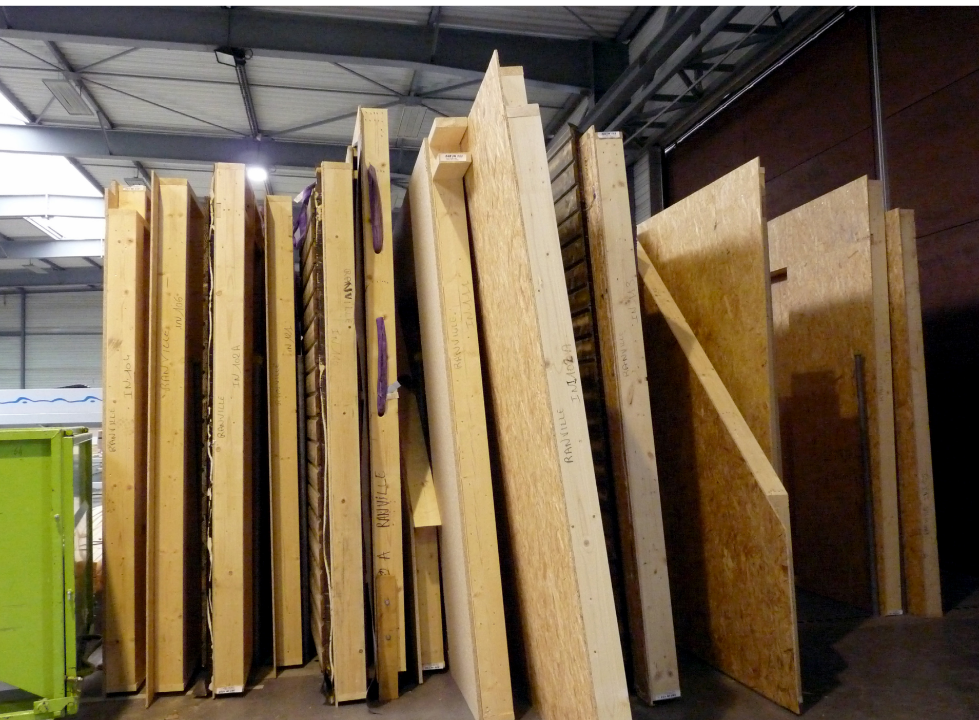
Figure 4. Photographie des murs à ossature bois fabriqués mécaniquement / Entreprise Cuiller frères
