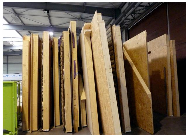
Figure 2. Photographie des murs à ossature bois fabriqués mécaniquement / Entreprise Cuiller frères
