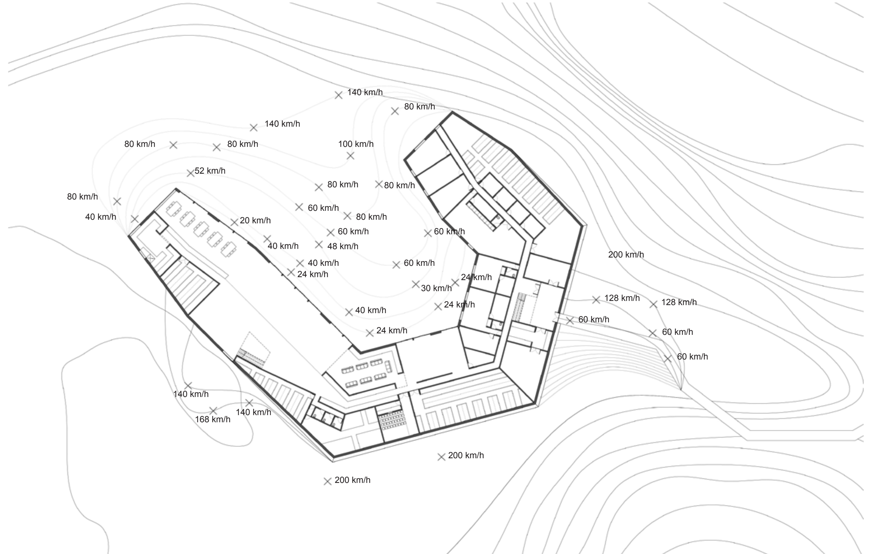
Visualisation des pressions et dépressions en façade avec les fils de lin
